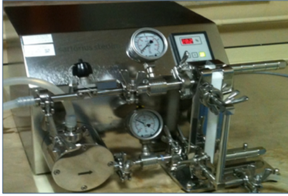
Şekil 1. Su örneklerinde filtrasyon işlemi için kullanılan cross-flow mikrofiltrasyon cihazının görünümü
