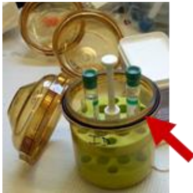
Şekil 3.8: a) Güvenlik kapaklı rotor b) Contalı kapaklı kefe
