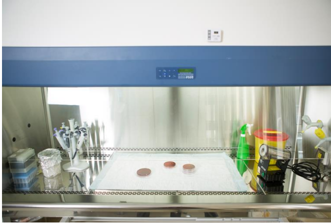
Şekil 10.16: BGK içinde çalışma düzenine örnek
