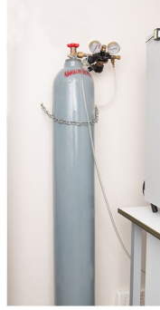
Şekil 8.12: Sıkıştırılmış gaz içeren tüplerin duvara sabitlenmesi
