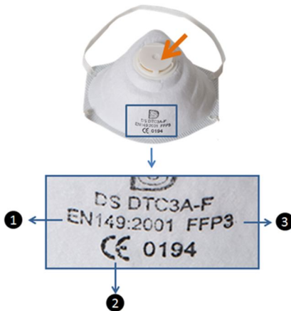
Şekil 11.18: Partikül filtreli bir respiratör. Resimde (1) EN149:2001 standardına uygunluğu, (2) CE belgesine sahip olduğunu ve (3) bunun FFP3 kategorisinde olduğunu gösterir işaretlerdir. Ok işareti maskenin valfini göstermektedir (metne bkz.)
